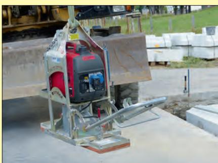
je nach Größe zwischen 110 kg bis 260 kg. Wie man sich doch täuschen kann! Transportiert und sachgerecht positioniert werden sie mittels eines Saugers, ohne diese Technik wären die Arbeiter chancenlos.
