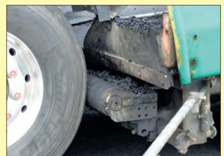
Jede Walze war mit einem Zusatzgerät versehen. In diesem befand sich feiner Splitt. Dieser wird beim Verdichten des Asphalt mit fest gewalzt. Somit wurde die Oberfläche abgestumpft.
