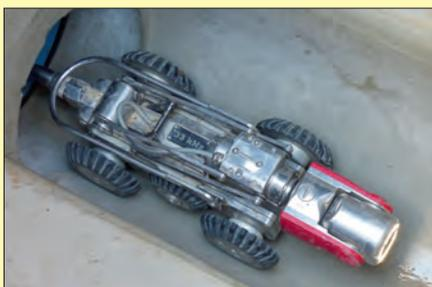
nalkamera, die einem Spielzeugroboter ähnelt, durch die Kanalisation gesteuert. Mit einer rundum laufenden Kamera wird das Rohr begutachtet. Sollten Fehler gefunden werden, müssen diese behoben werden.
