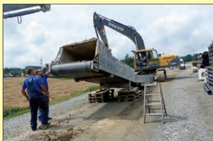
Eine größere Reparatur war bei der Prallmühle notwendig. Dazu wurde die Anlage auf die Trasse gefahren und in mehrere Teile zerlegt.
